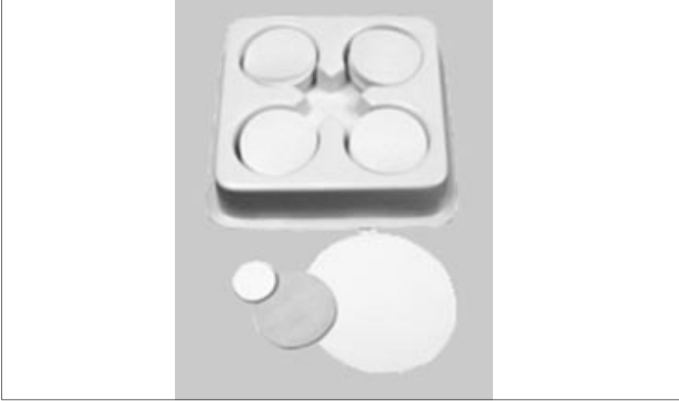
Şekil 1. Selüloz asetatından yapılmış 0.20 µm por çaplı 13 mm'lik membran filtreler.
