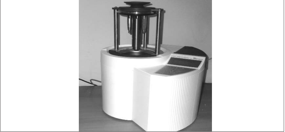
Şekil 3. Başlıklar için geliştirilmiş olan basınçlı buhar otoklavı.
