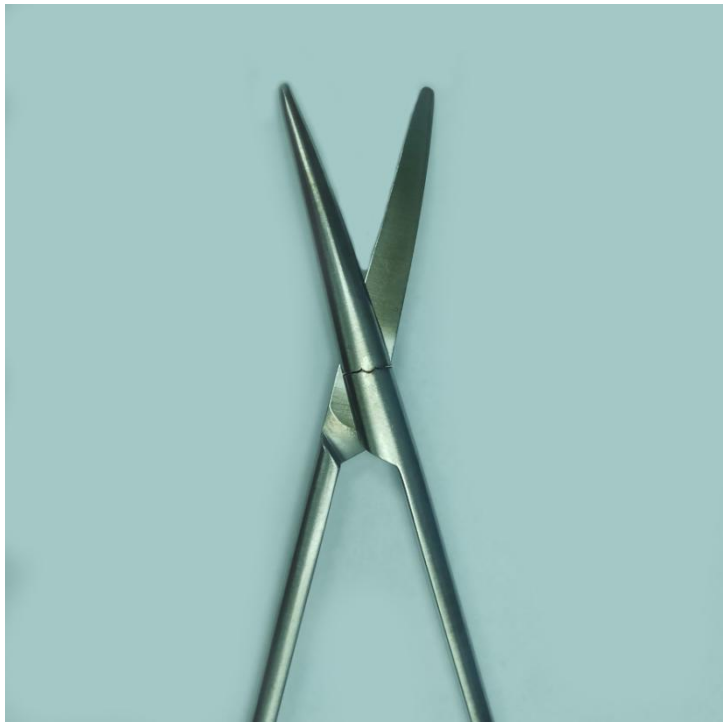
Resim 1. Eklem yeri çatlak makas
