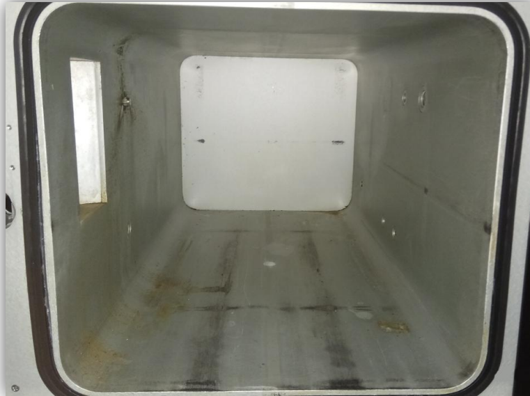
Resim 5. Etilen oksit cihaz kazan kirleri
