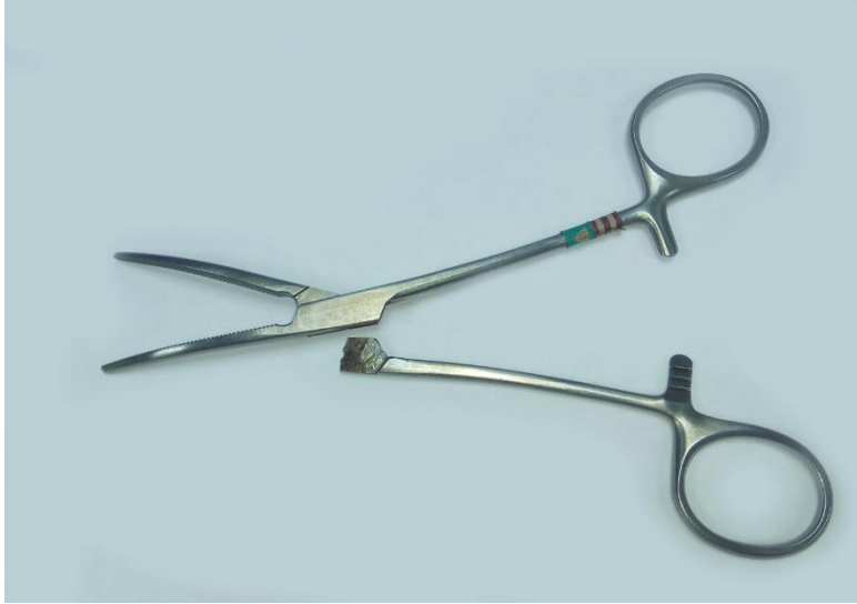
Resim 2. Kırık eğri klemp
