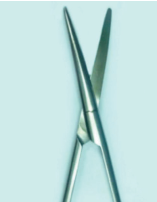
Şekil 10.2 Eklem yeri çatlak makas.
