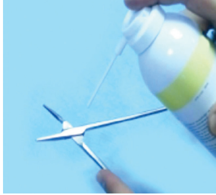
Şekil 10.4 Cerrahi tıbbi cihazların elle yağlama işlemi
